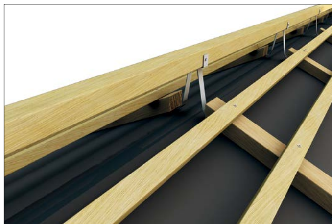
1. možnost: slemenska letev – namestitev na jekleni nosilec.
