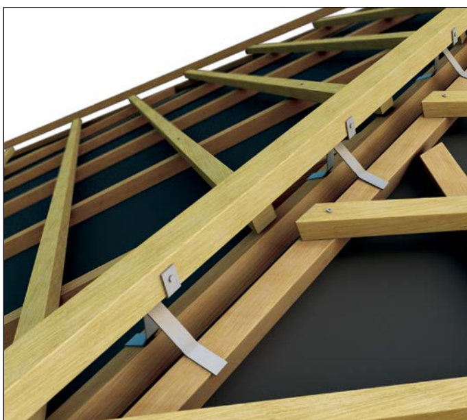
1. možnost: grebenska letev – namestitev na jekleni nosilec.
